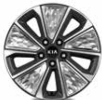
17-Zoll-Leichtmetallfelgen mit Bereifung 215/55 R17
